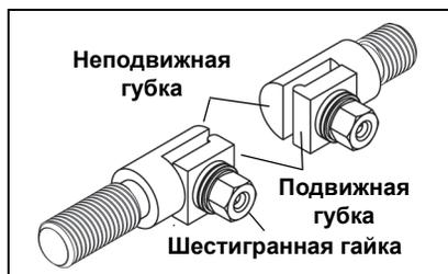
Ослабьте гайки на обоих зажимах, но не откручивайте их полностью. Губки на зажимах подпружинены, поэтому подвижная губка отодвинется от неподвижной. Вкрутите зажим с короткой резьбой в отверстие в верхней части корпуса тензодатчика. Вставьте длинную резьбу другого зажима снизу в отверстие в нагрузочной траверсе и накрутите на него сверху траверсы круглую гайку, зафиксировав зажим. **ПРИМЕЧАНИЕ.** Не затягивайте полностью круглую гайку на данном этапе.
