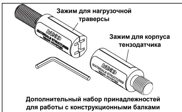
С помощью шестигранного ключа, входящего в комплект, открутите два винта, соединяющие две части зажима. Поместите концы конструкционной балки, например двутавровой балки №3, в неподвижные части обоих зажимов, а затем при помощи винтов прикрутите к ним подвижные части зажимов.
