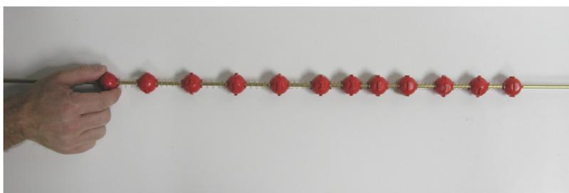
Рисунок 9: Демонстрация продольной волны
