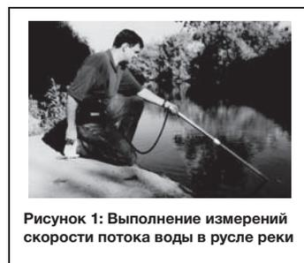
Рисунок 1: Выполнение измерений скорости потока воды в русле реки
