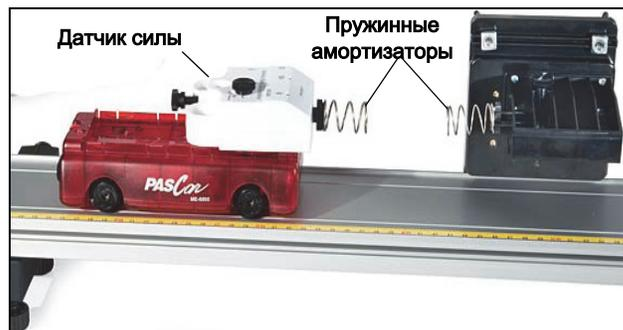
Если при установке кронштейна плоская поверхность платформы кронштейна будет направлена вверх, то датчик силы, установленный на платформе кронштейна, будет находиться на одном уровне с датчиком силы, установленном на тележке PASCO.
