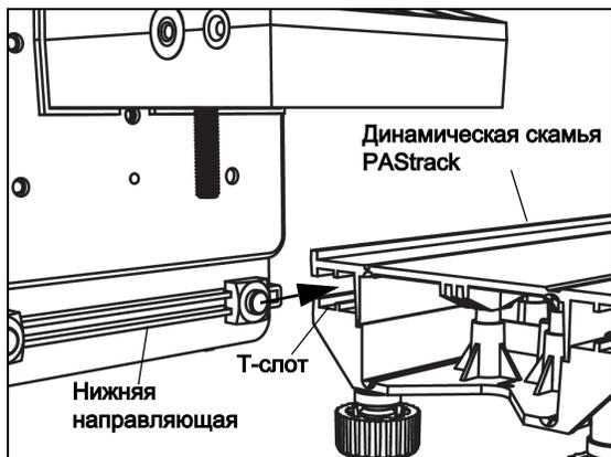
Кронштейн можно зафиксировать в Т-слоте на любой стороне скамьи PASCO. К динамической скамье можно присоединить верхний или нижний конец кронштейна. Если платформа кронштейна направлена вниз, то датчик силы, устанавливаемый под платформой, будет находиться на скамье на одном уровне с тележкой PASCO.
