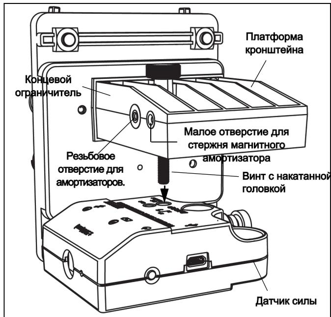
Затяните винт с накатанной головкой на датчике силы до плотной фиксации датчика в нижней части платформы кронштейна.
