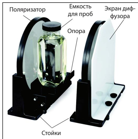
Заполните емкость для проб оптически активным веществом, таким как кукурузный сироп, и поместите ее в опору между двумя поляризаторами. Пропустите луч света через экран диффузора, поляризатор и пробоборную бутылку. Отрегулируйте второй поляризатор для измерения угла вращения.
