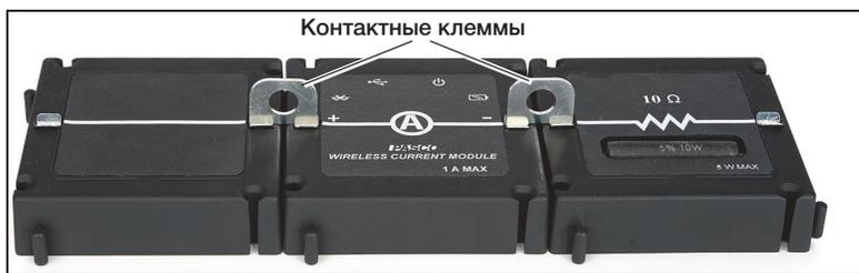
**Использование:** чтобы подключить модуль беспроводной для измерения силы тока PASCO к общей схеме модульных плат с целью измерения тока в цепи, используйте контактные клеммы. Модуль беспроводной для измерения силы тока PASCO EM-3534 разработан компанией PASCO (Калифорния, США). Устройство изготовлено в Китае.
