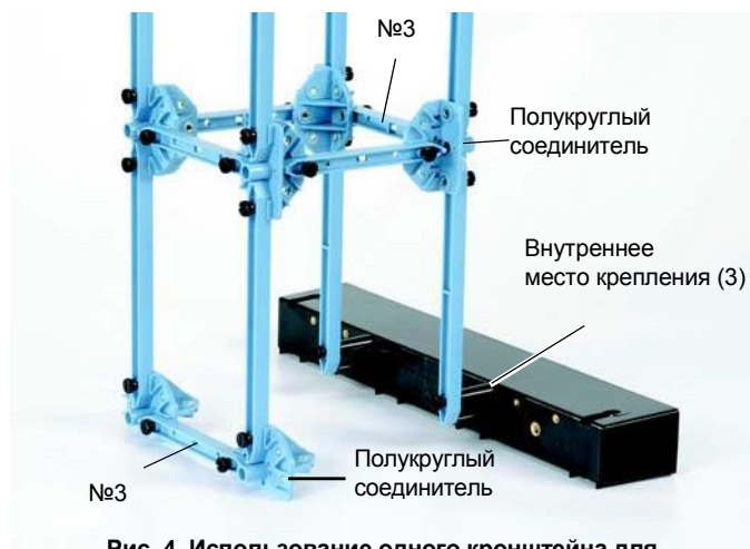
Рис. 4. Использование одного кронштейна для крепления конструкций к силовой платформе
