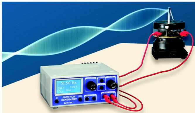
**Управляемое гармоническое движение** Можно приводить в движение массу, висящую на пружине, и сравнивать амплитуду колебаний с приводной частотой. Используйте струнный держатель с пробкой, чтобы прикрепить пружину к приводному рычагу. Резонансные режимы соединенных осцилляторов можно изучать с помощью «планеров», перемещаемых по полой воздушной «трассе», или перемещаемых по «трассе» ходунков, соединенных пружинами.
