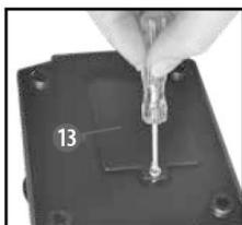
Батарейный отсек расположен в основании микроскопа (рис. 2, 13). Ослабьте винт на крышке батарейного отсека с помощью небольшой крестовой отвертки и снимите крышку. Убедитесь, что элементы питания установлены в соответствии с полярностью (+ и –), указанной на батарейке и внутри батарейного отсека. Закройте крышку батарейного отсека и разверните микроскоп.
