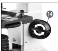
Всегда начинайте наблюдение с объектива с наименьшим увеличением. Опустите предметный столик (рис. 1, 9) в нижнее положение (рис. 4, 14). Поверните револьверное устройство (рис. 1, 6), чтобы выбрать объектив с наименьшим увеличением (4х).
