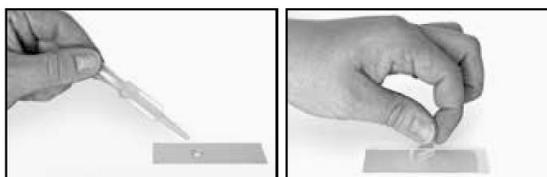
Смола для изготовления препаратов (18b) (входит в комплект поставки) предназначена для изготовления постоянных микропрепаратов. Используйте ее вместо воды. Используйте смолу, если вам необходимо зафиксировать препарат на стекле.
