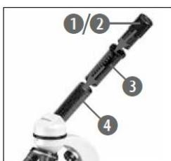
Затем вставьте окуляр WF10x (рис. 5, 1) в линзу Барлоу (рис. 5, 3). Убедитесь, что линза Барлоу полностью вставлена в окулярную трубку (рис. 5, 4).
