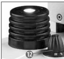
Подсветка освещает объект наблюдения сверху и снизу. (То, что вы наблюдаете под микроскопом, называется объектом наблюдения или препаратом.) Вы можете использовать верхнюю или нижнюю подсветку, или обе одновременно. Выберите необходимый режим при помощи переключателя подсветки (рис. 3, 12).
