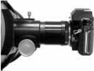
Т-адаптер соединен с фокусирующим устройством и камерой,
